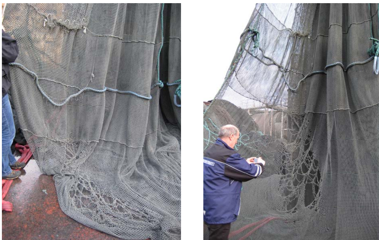
Figur 3: Hull, oppfliset notlin, løst bunntau og dobbelt notlin.
